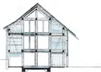
Schema des Holztragwerks mit Betonkern.
