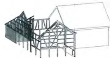
Schema des Holztragwerks mit Betonkern.
